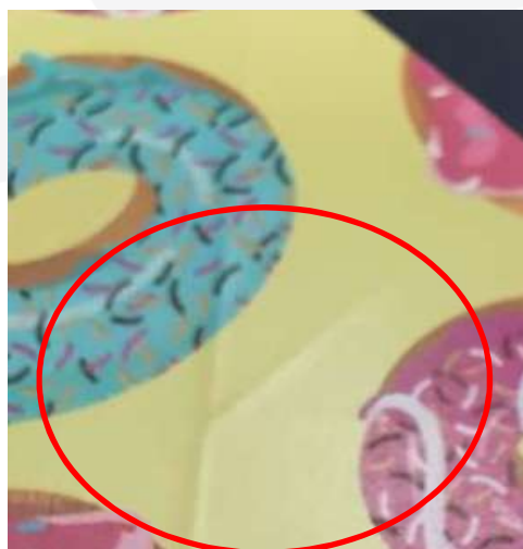
Hendido sobre la cara trasera, la impresión no se rompe
