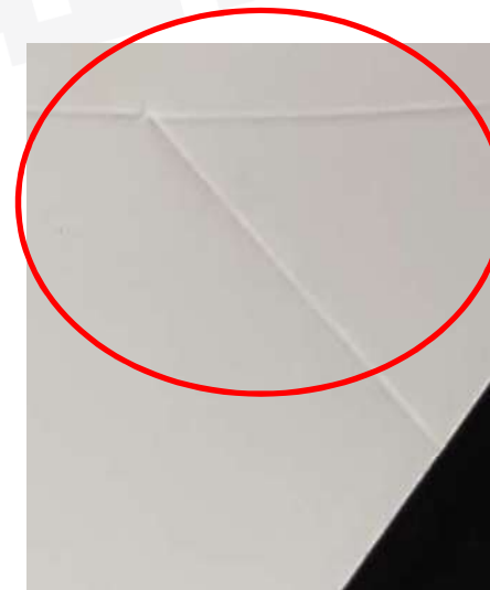
Hendido sobre la cara trasera, la impresión no se rompe
