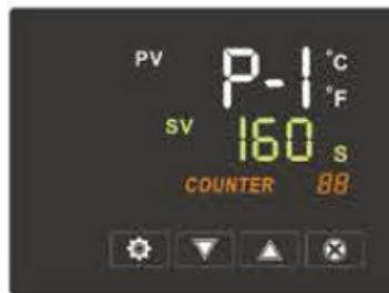
Pulse **SET** hasta que aparezca **P-1 Temperatura**, con las teclas **▼▲** incremente o decremente los grados.
