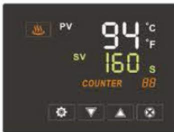
Al encender la plancha, el controlador con pantalla LCD se iluminará. **PV** indica el valor de temperatura actual.
