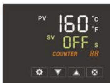
**Instrucciones Stand By.** Si **SV** marca el valor **OFF**, la prensa comenzará a enfriarse, el modo de espera se activa cuando la máquina no está en uso según lo establecido en P-5. Si presiona cualquier botón en la pantalla de control volverá a activarse.
