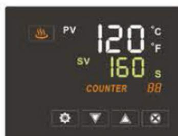
Finalmente pulse **SET** para terminar la configuración. Cuando el indicador **PV** alcance la temperatura configurada podrá pulsar la doble botonera, comenzando la transferencia, cuando termine el tiempo el plato de calor se abrirá automáticamente.
