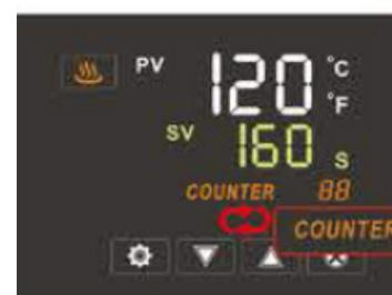
**Instrucciones Contador.** El contador del display LCD incrementa un número en cada ciclo de tiempo y sirve de ayuda para recordar cuantas camisetas se han transferido. Si quieres reiniciar el contador realiza una pulsación larga sobre Counter Clear **⊗**
