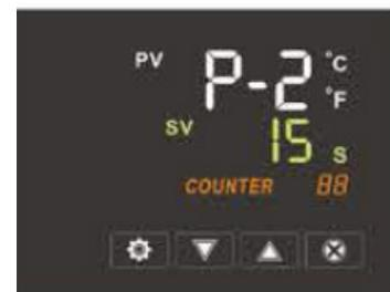
Pulse **SET** hasta que aparezca **P-2 Tiempo**, con las teclas **▼▲** incremente o decremente los segundos.
