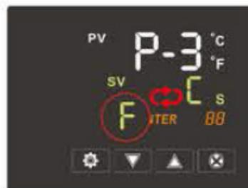
Pulse **SET** hasta que aparezca **P-3 Escala de temperatura** y las teclas **▼▲** para cambiar de la temperatura de grados Celsius a Fahrenheit o viceversa.
