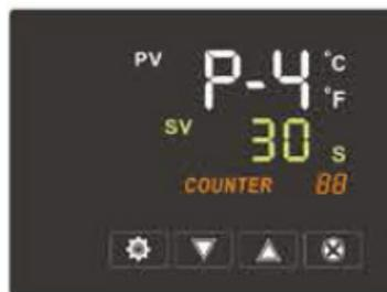
**P-4 Ajuste de presión.** Pulse **SET** y **▼▲** para ajustar los diferentes niveles de presión en rango de 1 a 35. Para textil las presiones típicas van de 28 a 35.
