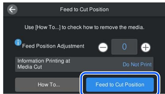
El cambio del **Ajuste de la posición de alimentación** le permite ajustar la velocidad de alimentación con respecto al valor estándar. Si desea ajustar los márgenes de los resultados de impresión, ajuste la posición de alimentación y, a continuación, pulse **Alimentar hasta la posición de corte.**
