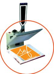
Retire y/o pele el flock sobrante, y aplique el flock impreso a una temperatura entre 160-170°C unos 15 segundos.
