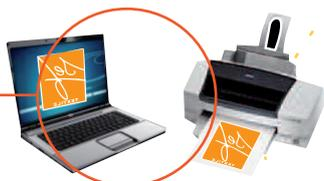
Escanee, importe o cree un diseño vectorial con software como Corel, Illustrator®. Desde el driver de la impresora, "Imprima en espejo". Ha de utilizar una impresora de sublimación con papel transfer.
